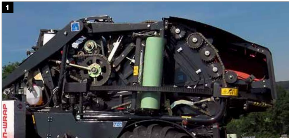
1 Transmission robuste avec chaînes IWIS de qualité supérieure
