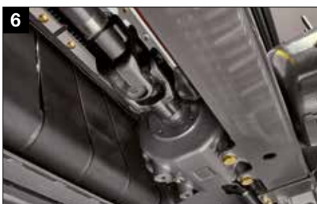
Arbres d'entraînement avec joints de cardan intégrés
