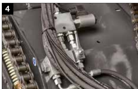
4 Contrôle de couteau / trappe actionnés DROPFLOOR séparé standard, actionné depuis le terminal
