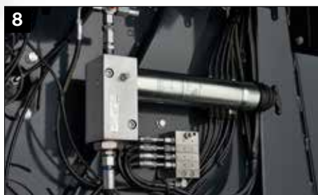
Système de graissage automatique des roulements de série
