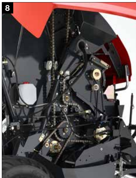
Transmission robuste avec chaînes IWIS de qualité supérieure + transmission primaire 1¼" 20BH avec broches en chrome durci
