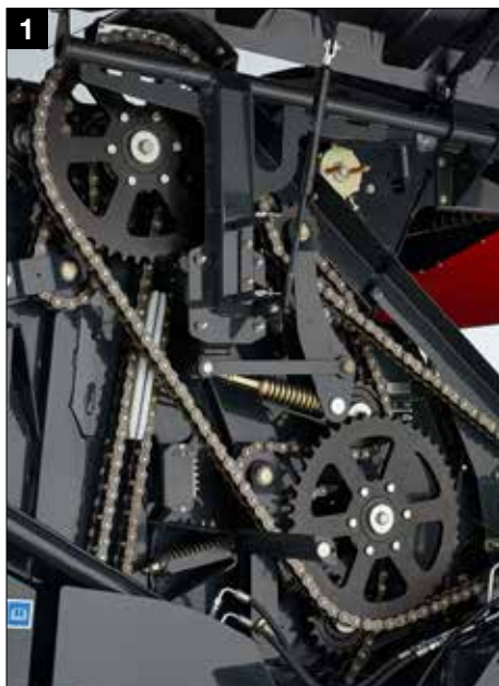
1 Transmission robuste avec chaînes IWIS de qualité supérieure
