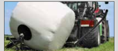
Dépose balle vertical pour que la balle se retrouve sur sa partie plate
